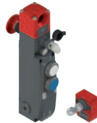
Betätiger verriegelt bei **deaktiviertem 24 Vdc Elektromagnet. Mit Hilfsentsperrung mit Schloss und Fluchtentsperrungstaster und Schutzmantel.**
